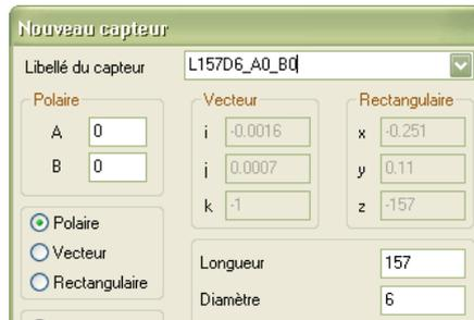
**Remarque :** lorsqu'on crée un capteur, il est nécessaire de le calibrer dans toutes les positions. Pour cet atelier, nous nous contentons de la calibration existante. Par ailleurs, on peut constater que le logiciel a inséré une nouvelle ligne dans le programme.
