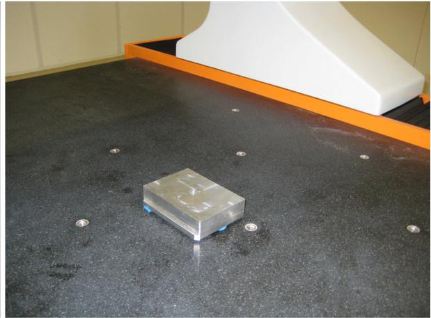
**Remarque :** le positionnement n'a pas besoin d'être précis car nous allons définir un système d'axes associé aux surfaces de la pièce (dégauchisage). Il faut néanmoins respecter l'orientation par rapport aux axes X, Y, Z de la machine pour être cohérent avec la procédure ci-après.
